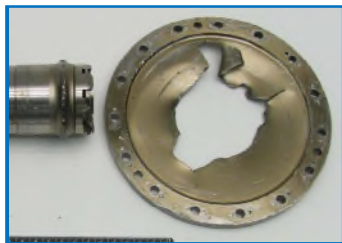
RGB インプット・シャフト破断状況
