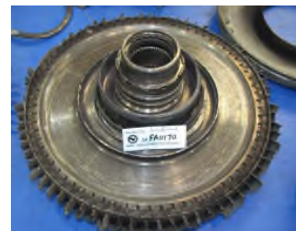
破断した PT ブレード
