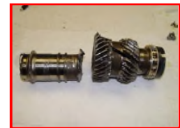
RGB ヘリカル・インプット ・ギアシャフトの破断状況
