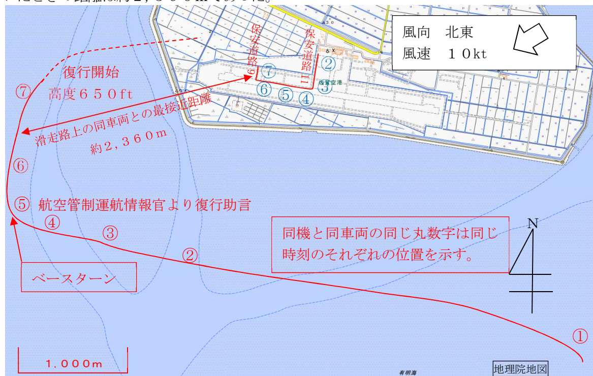
図1 同機と同車両の位置（同機の位置：レーダー航跡 同車両の位置：空港監視カメラ）
