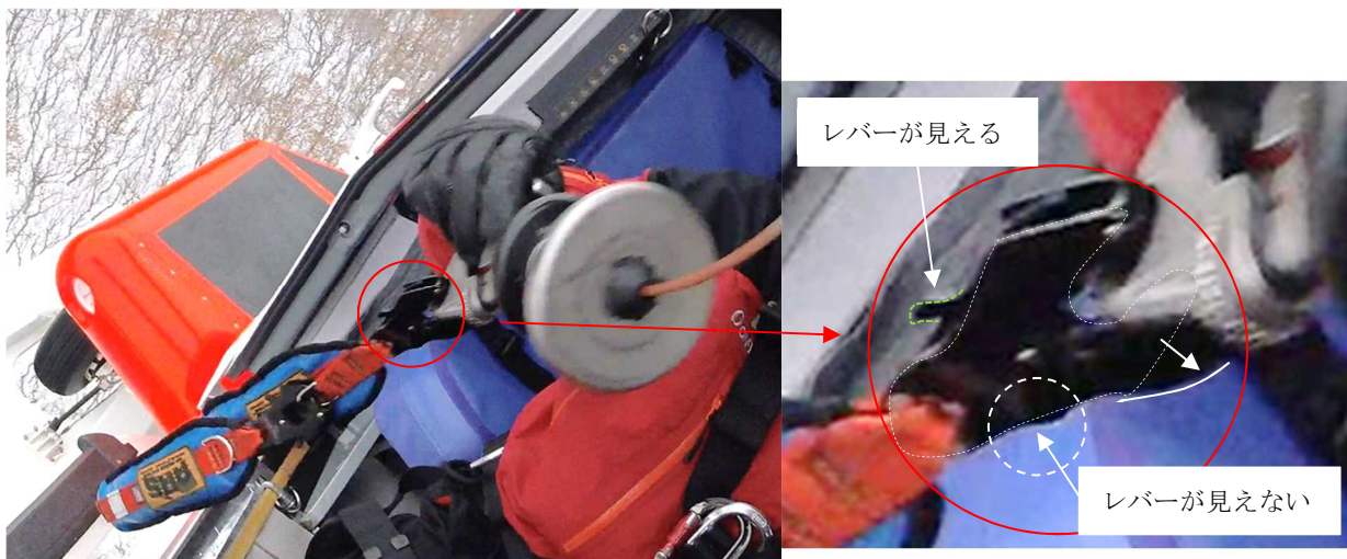
図6 機外放出直前のフックの状況
