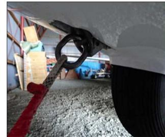
図2 B機の曳航索離脱装置
