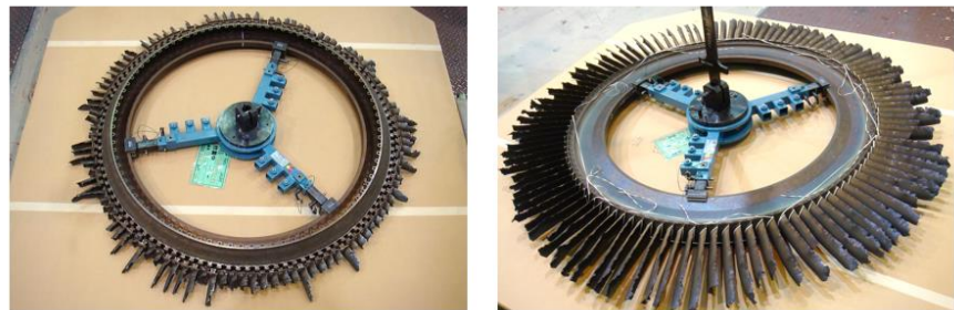
図4 LPT第5段(左側)及び第6段(右側)動翼の損傷状況
