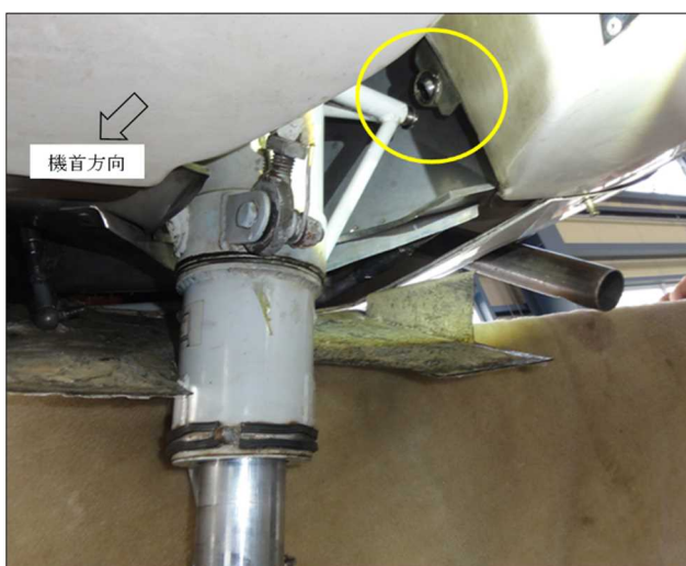
図4 前脚右側取付部の脱落状況
