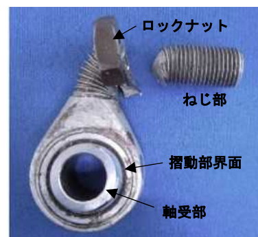
写真4 ロッドエンドベアリング (撮影：物質・材料研究機構)
