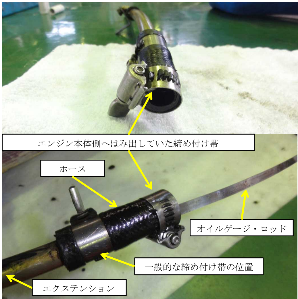
写真B ホース締め付け金具の状況
