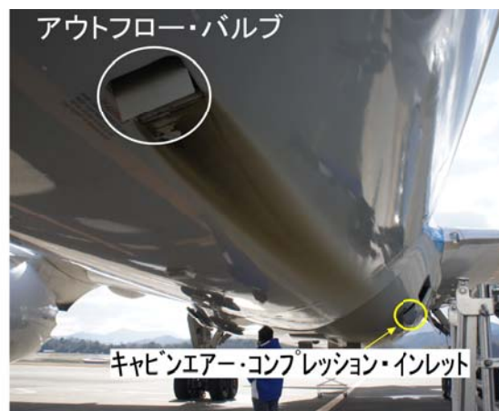
写真 2.8.3-1 アウトフロー・バルブ付近の状況
