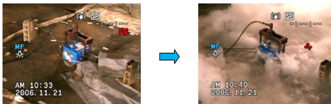
写真 2.12.7.1 開発時の内部短絡（釘刺し）試験
