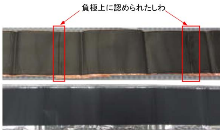
写真 2.11.2 分解したセルの負極(上段)及び正極(下段)
