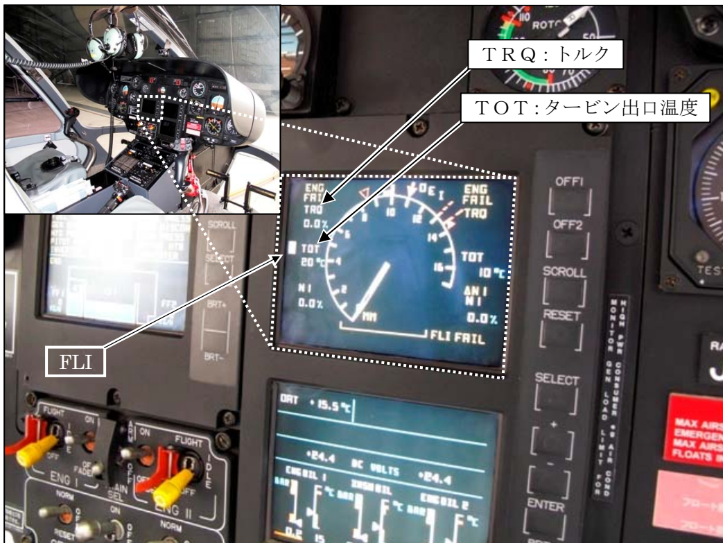
写真2 エンジン計器の表示例
