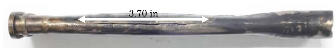
同チューブを覆うヒートシールドを外した状態
