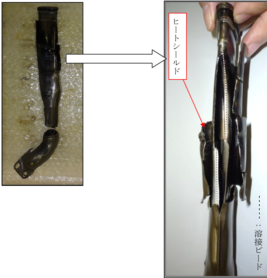
写真5 同チューブの亀裂部
