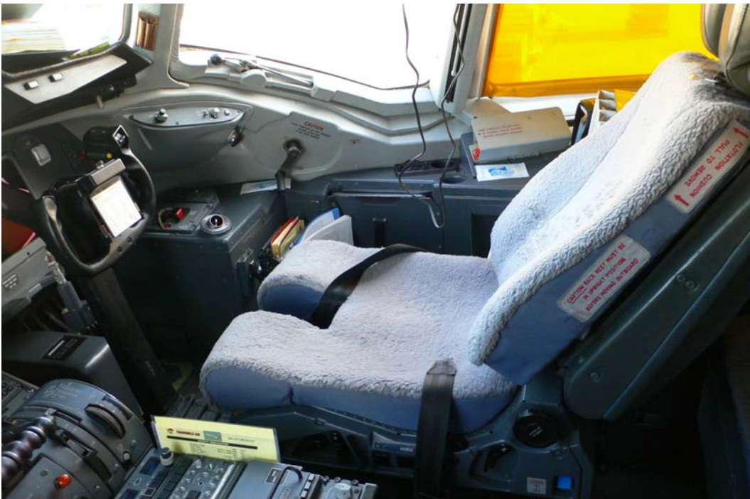
写真2 副機長が着座していた右操縦席 (後方へ移動させ、背もたれを後方へ倒した状態)
