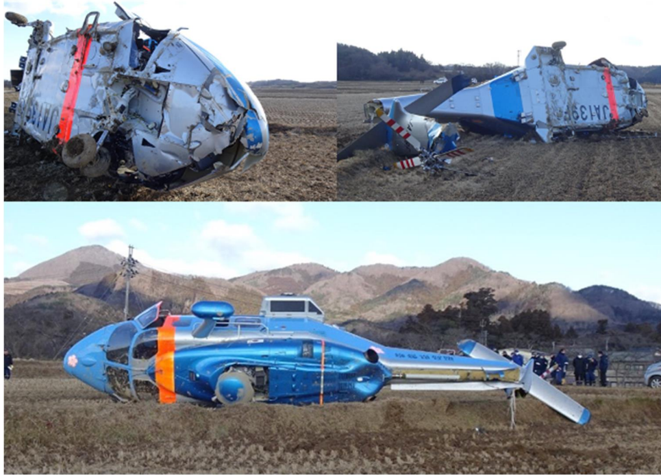
図4 事故機の横転状況
