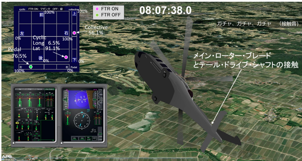
図28 メイン・ローター・ブレードとテール・ドライブ・シャフト接触時の機体姿勢と操縦装置の位置
