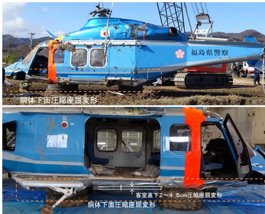
図8 胴体及び着陸装置の損傷
