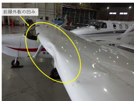
図2 損傷箇所（前縁外板）
