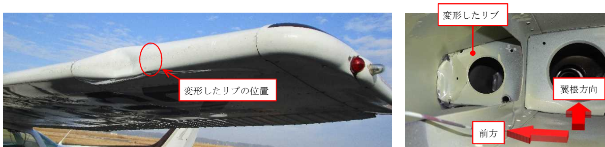
図1 事故機の損傷箇所（右図は左主翼内部を翼端側から撮影したもの）
