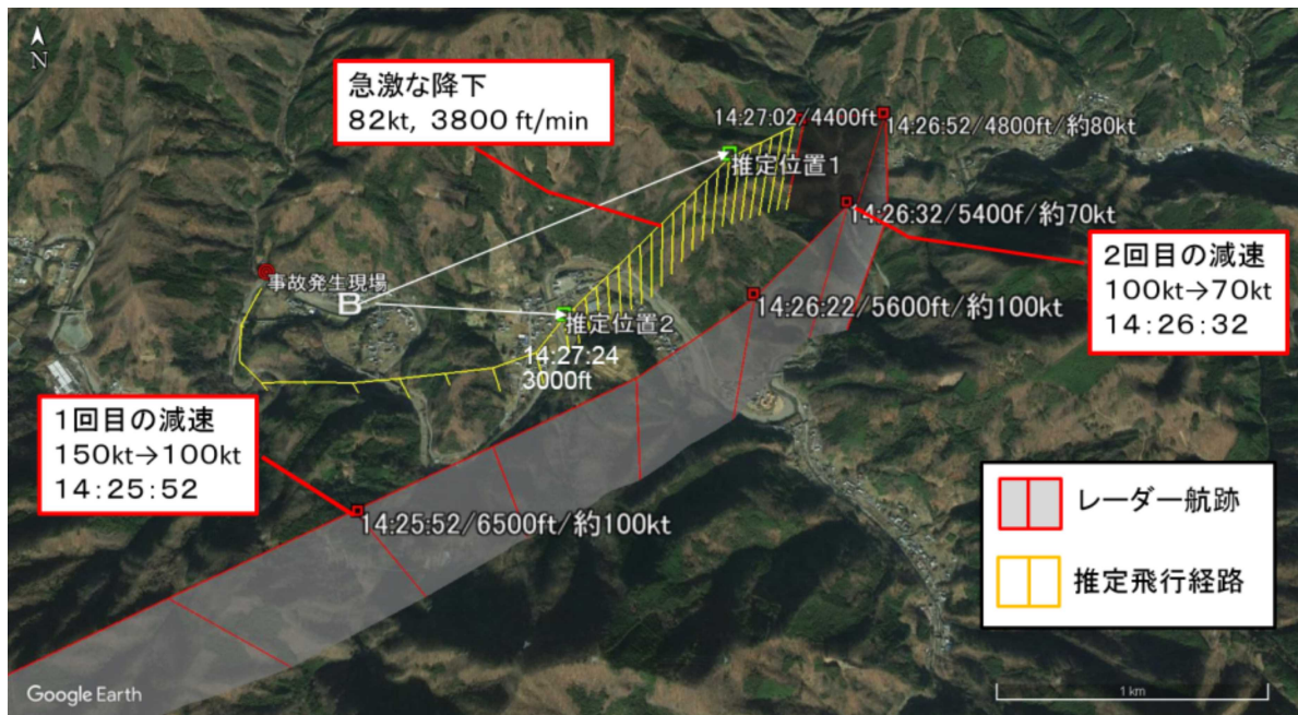
図6 同機の非常操作時の急激な降下
