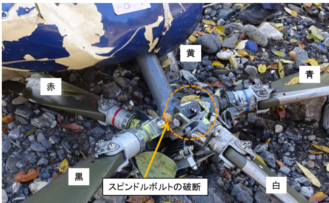
図11 白色ブレードのスピンドルボルトの破断
