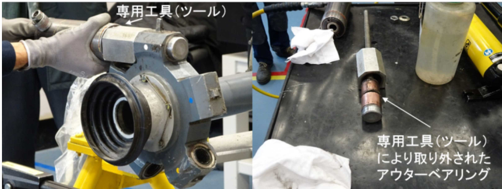
図 2 5 専用工具 (ツール) により取り外されたアウターベアリング
