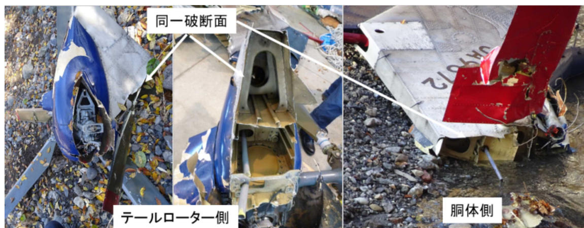
図32 機体から分離したテールローター下部の破断面
