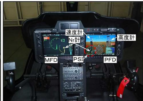
図8 ベル式505型の計器
