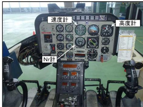
図7 ベル式206型の計器
