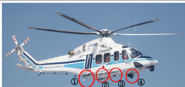
図1 同機の損傷発生箇所
