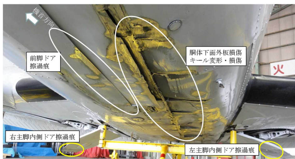
写真3 機体下面の損傷状況
