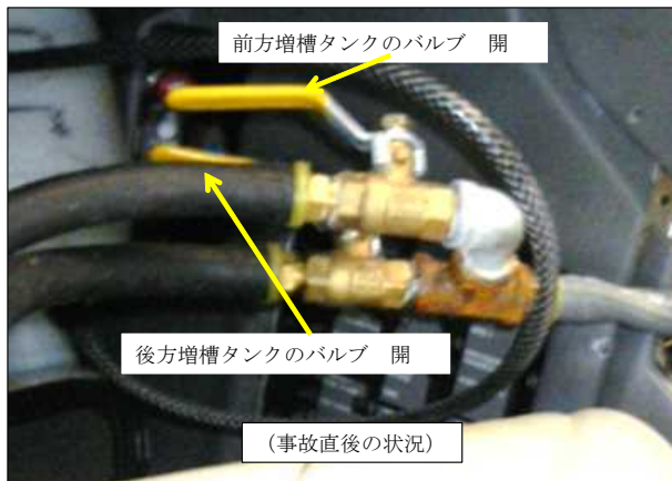
写真C 各タンクの燃料セレクター・バルブの状況
