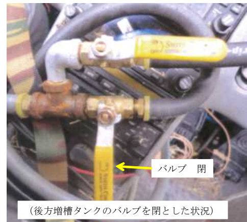
写真C 各タンクの燃料セレクター・バルブの状況
