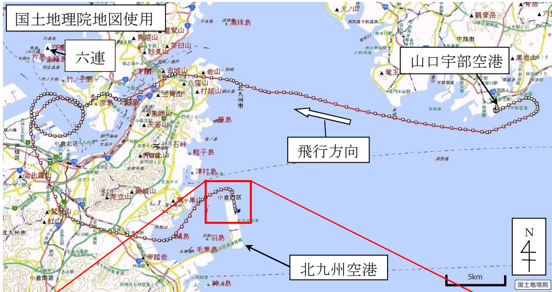
付図1 GPS受信機の記録による推定飛行経路
