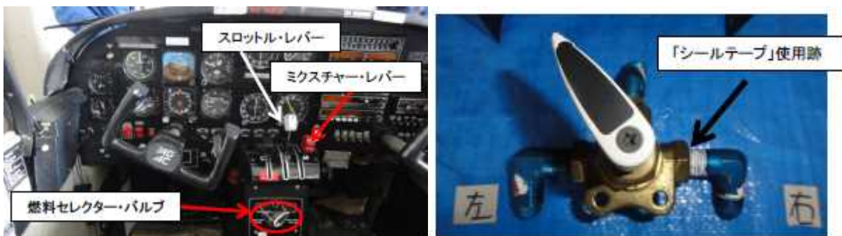
写真1 同機の燃料セレクター・バルブ
