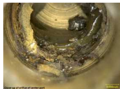
写真4 バルブ出口に付着していた物質
