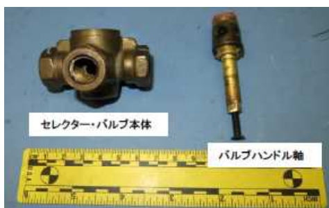
写真3 燃料セクター・バルブの検査
