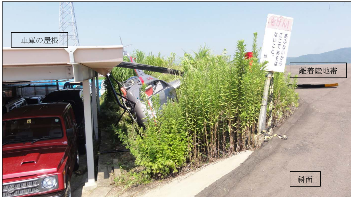
(離着陸地帯南側法面に横倒しとなった状態)
