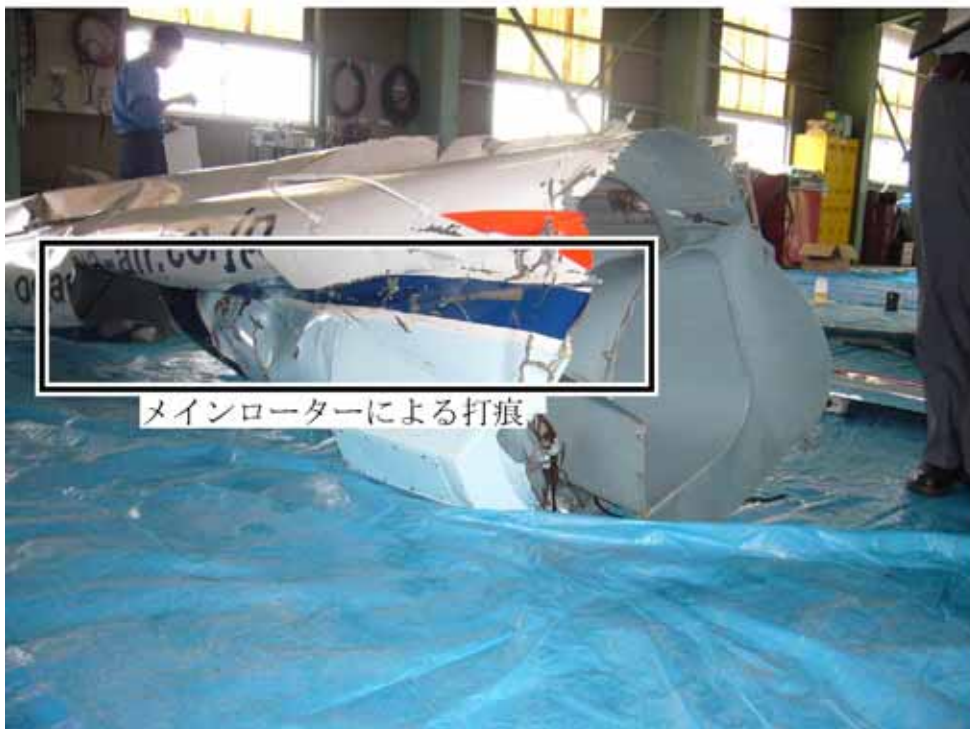
写真5 テールブームの状況
