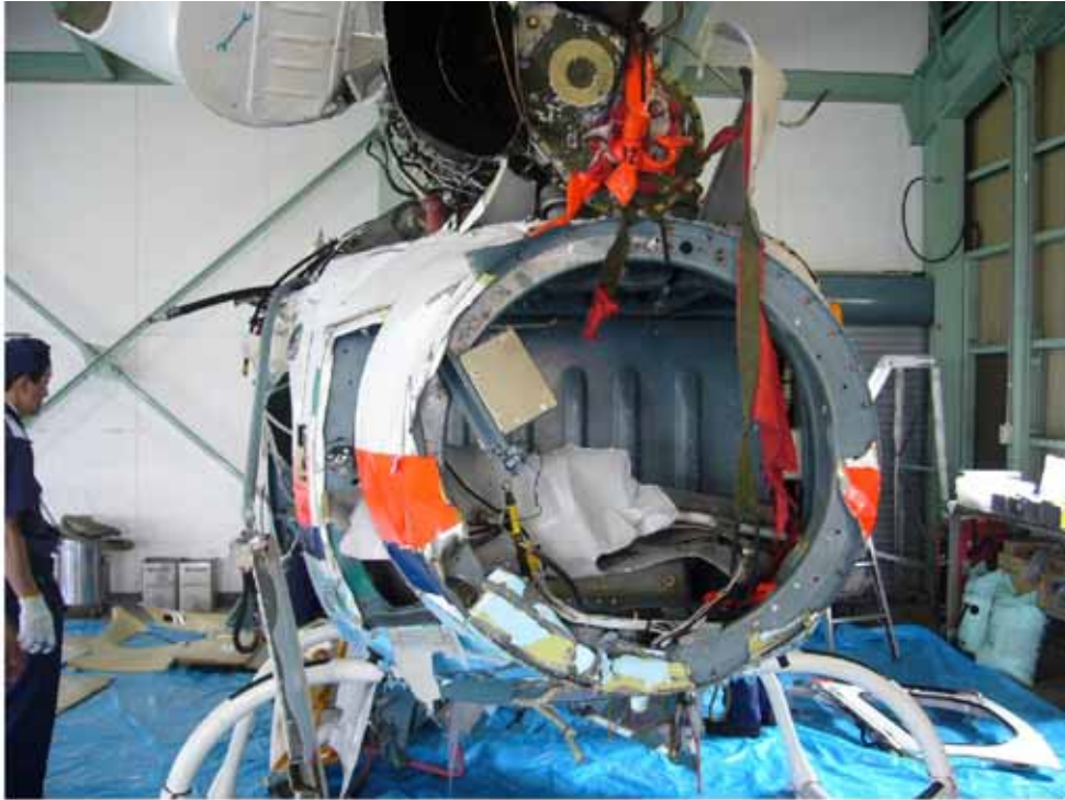
写真4 テールブーム取付部の状況
