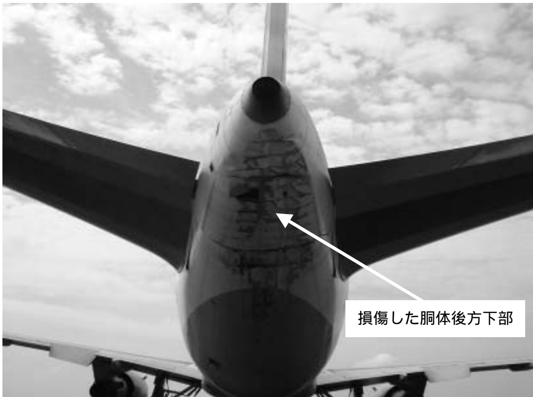
写真2 胴体後方下部の損傷状況
