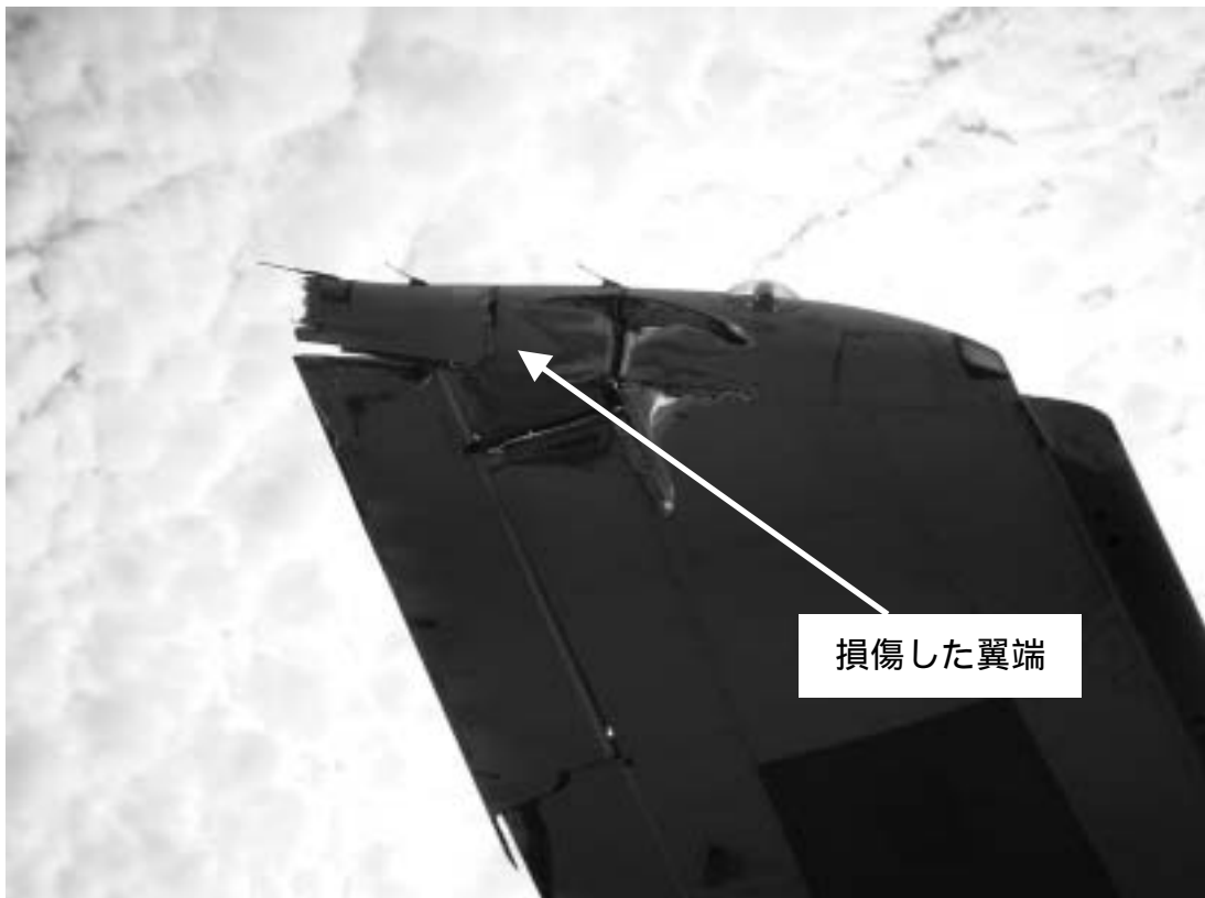
写真4 右主翼の損傷状況
