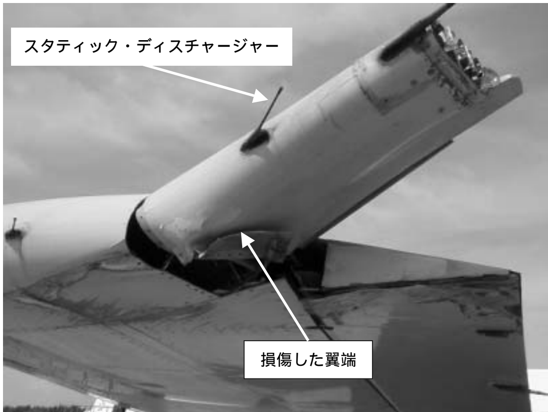
写真5 左主翼の損傷状況
