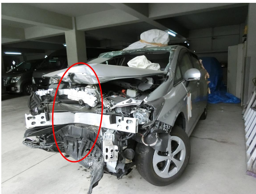
写真1-3 当該車両（左前方から：○印は電柱との衝突部分）
