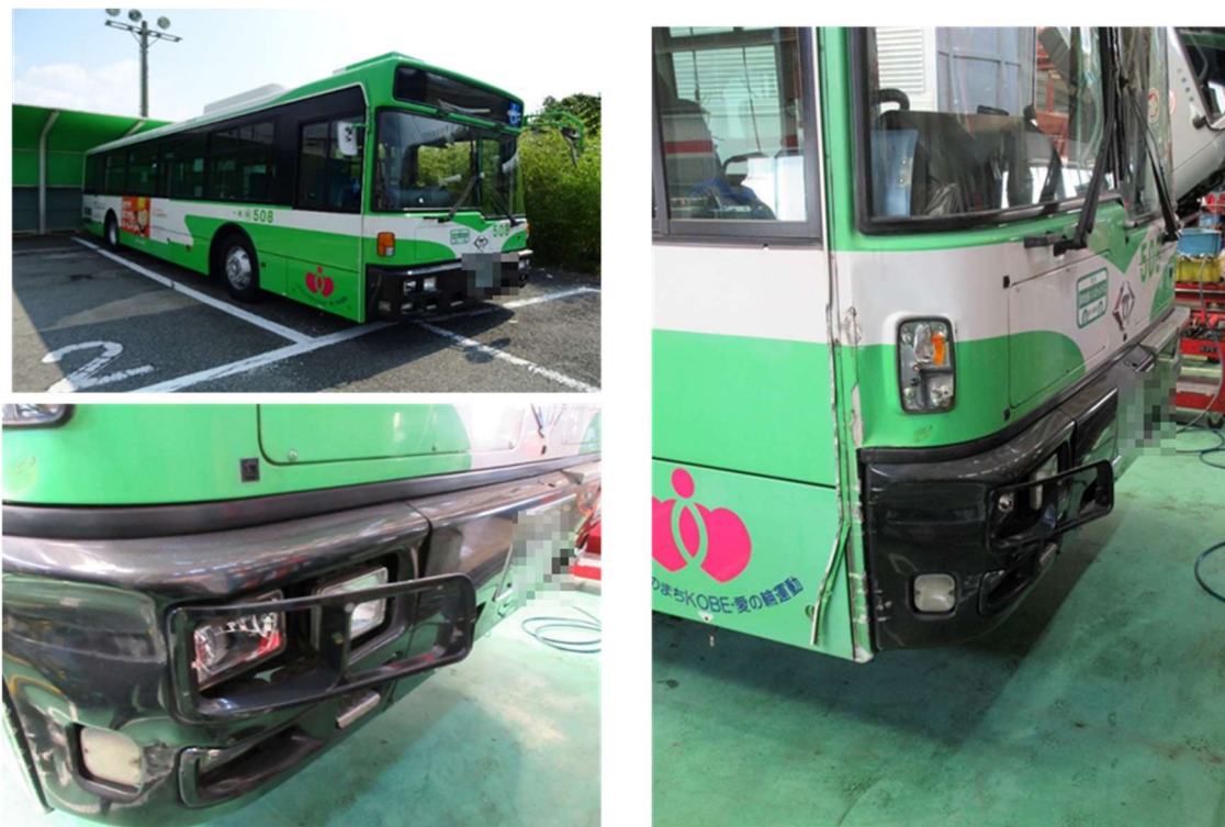
写真3 当該車両損傷状況
