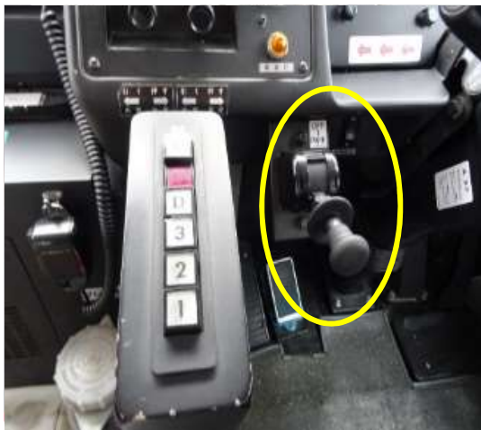
写真1 変速装置及び サイドブレーキレバー(黄色部分)
