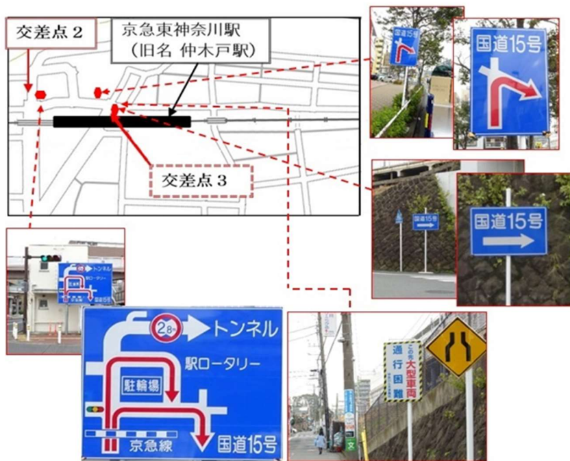
写真1-7 事故後改善された案内標識等
