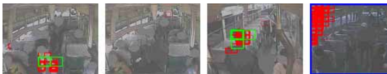
図2 動領域の抽出例(右端の図は、明るさ変化などの「画面全体の変化」に対する判定)
