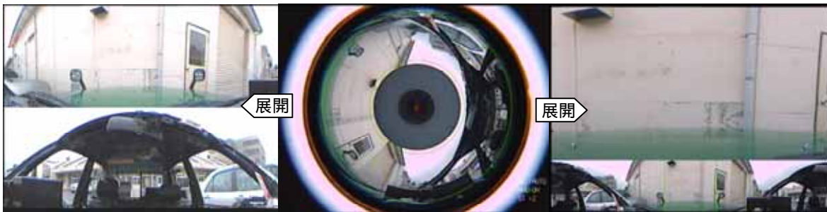
図2 全周カメラモジュールの映像記録 (真中の環状記録を上下に分割する記録(左)、任意領域を拡大する(右)記録に展開できる) 2種類の展開処理形式を今回の実験に活用
