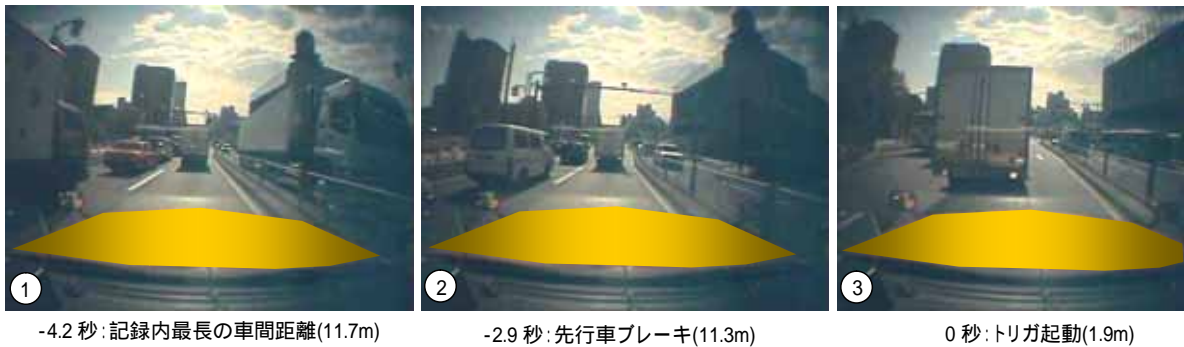
図 11 追突ニアミス事例(交差点直前で急減速した前方トラックへ急接近)、( )は車間距離
