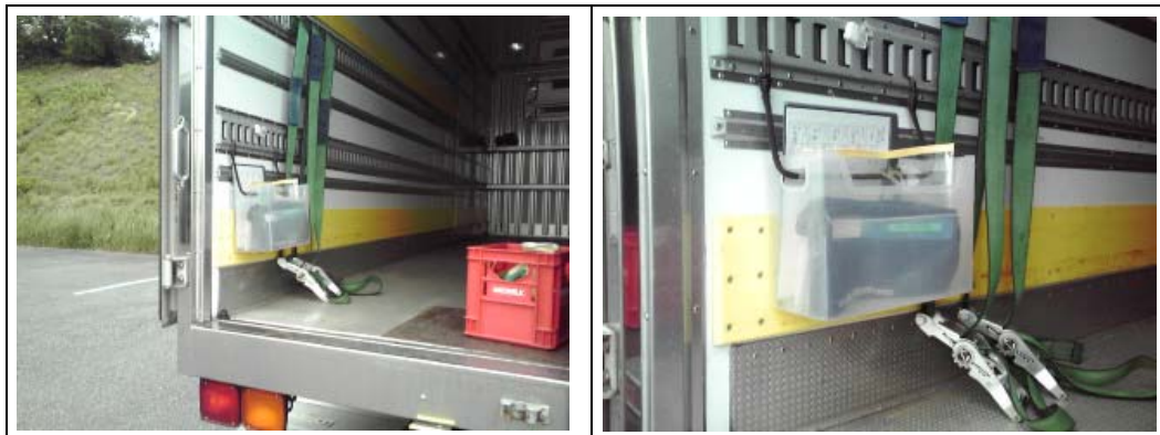
図3 事故後に改善された伝票収納ボックス（荷箱内の側面に設置）
