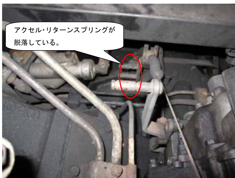
図 1 当該事故車両のアクセル・リターンスプリングの状況
