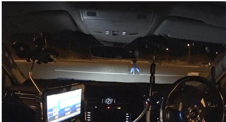
CPFシナリオ(警報発生時)
