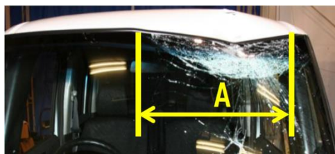
【窓枠上部の間隔】
