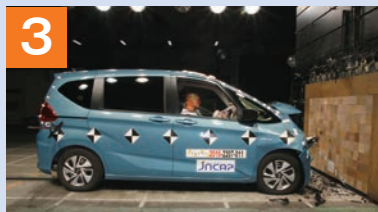
フルラップ前面衝突試験直後の様子
