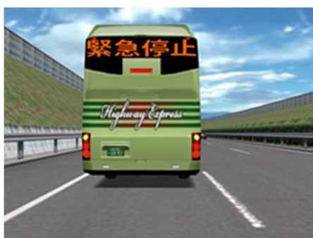
図 2-18 車外の道路ユーザーへの文字による報知例（ドライビングシミュレータ）
