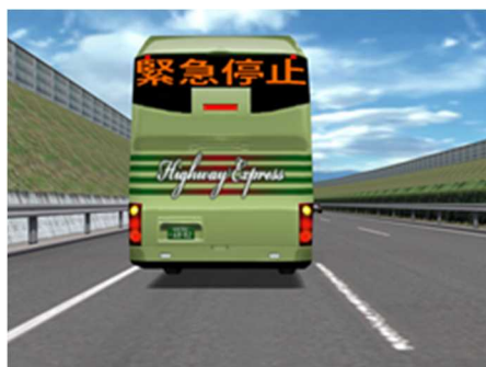
図 C-3 『緊急停止』表示による報知の DS スクリーン画像の例
