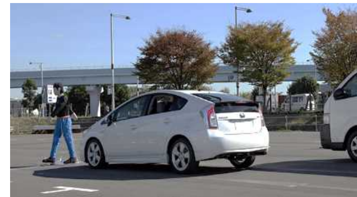
対歩行者衝突被害軽減ブレーキ試験(昼間)のイメージ
