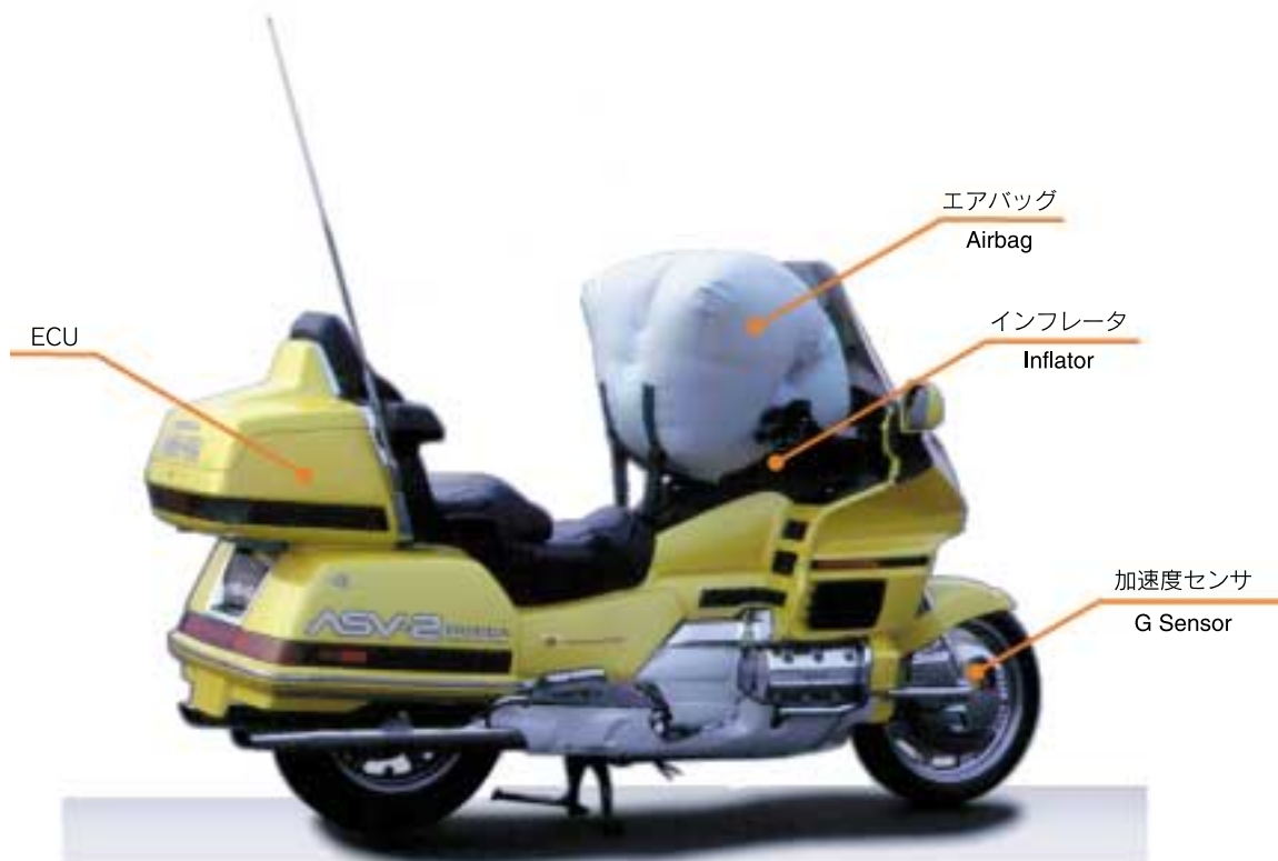
装置の構成 System Structure
