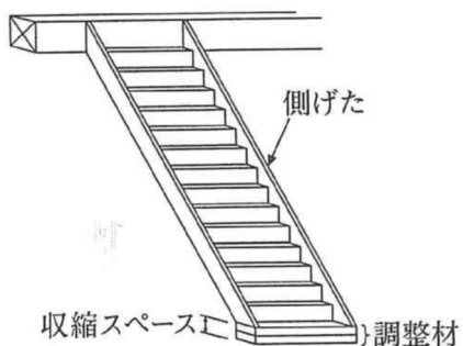
図8.9.5 階段の取付け
