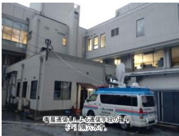
衛星通信車による通信手段の確保
