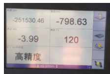
ICTバックホウの刃先等の施工履歴データを記録
