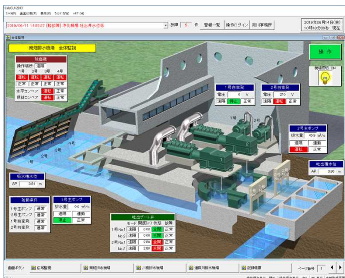
排水機場監視画面
