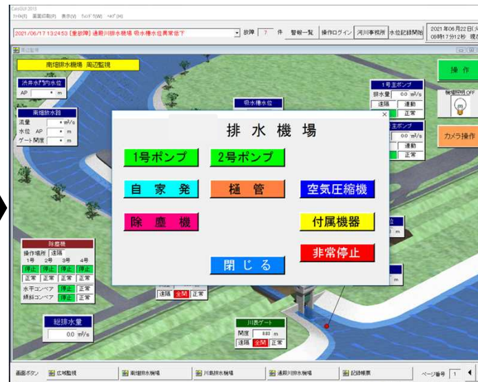
排水機場操作画面（装置選択画面）
