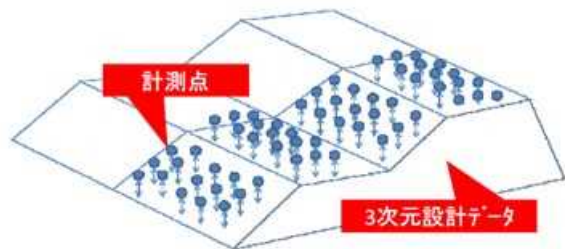
図-1 点群データによる全数管理の考え方
