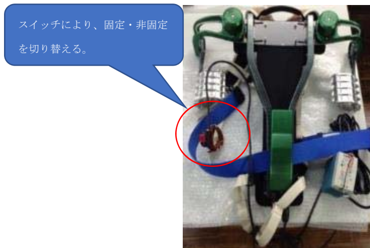
電磁ブレーキ式のアシストスーツ(図1)
