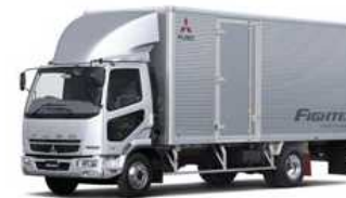
バンボディ： 荷台がアルミ製の箱型のトラックです。平ボディよりも風雨から荷物を保護することができます。ただし、ボディの重量によって積載量は4トン以下に減少します。
