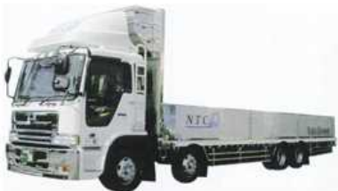
平ボディ： 荷台がフラット型の汎用的なトラックです。11～15トンの最大積載量が確保できます。
