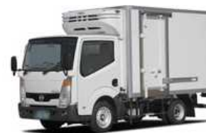
冷凍冷蔵車： 冷凍・冷蔵装置が付いて、荷台が冷凍庫や冷蔵庫になるトラックです。冷凍食品を運んだり、生鮮食品を新鮮なまま運ぶことができます。
