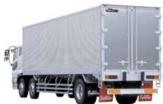
バンボディ： 荷台がアルミ製の箱型のトラックです。平ボディよりも風雨から荷物を保護することができます。
