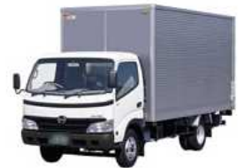
バンボディ： 荷台がアルミ製の箱型のトラックです。平ボディよりも風雨から荷物を保護することができます。現在では最も一般的なトラックです。
