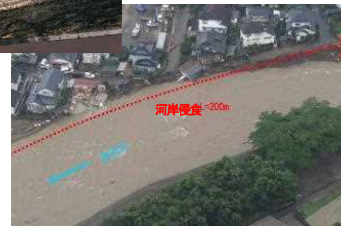
河岸侵食に伴う家屋倒壊等
