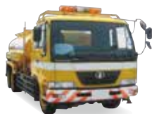
道路清掃用散水車
