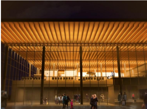
●内観(木梁に県産材を利用した屋根)
