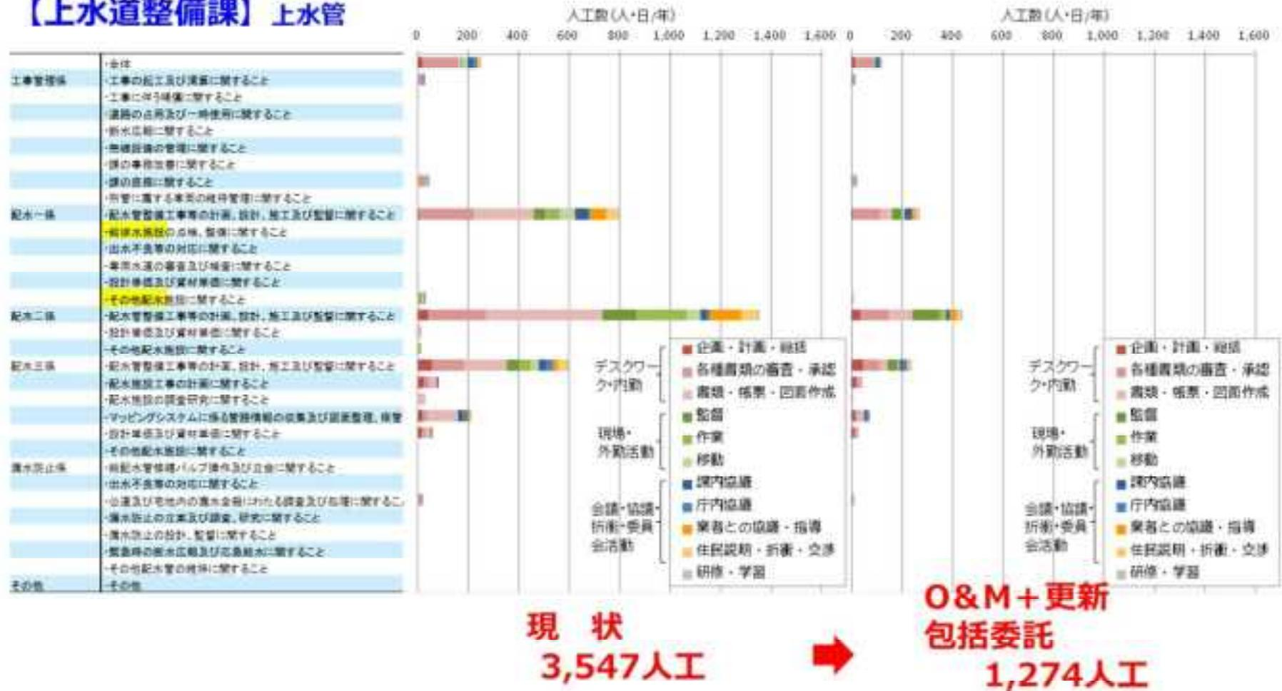
図 6.25 水道管路への PPP/PFI 導入による職員負荷削減効果(上水道整備課、H27 ベース)
