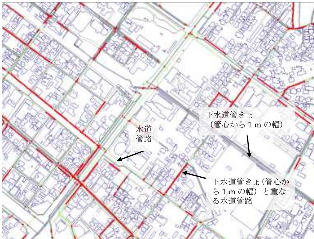
図 5.7 共同工事候補箇所の例 2
