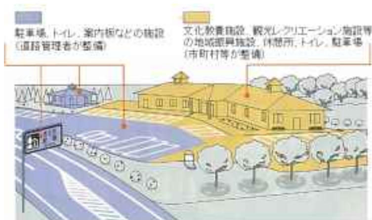
図 3-24 道の駅の設備と整備主体
